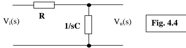
Al circuito di Fig. 4.4 possiamo applicare le regola del partitore, a patto di considerare per il condensatore la sua impedenza  $Z_C$ .
