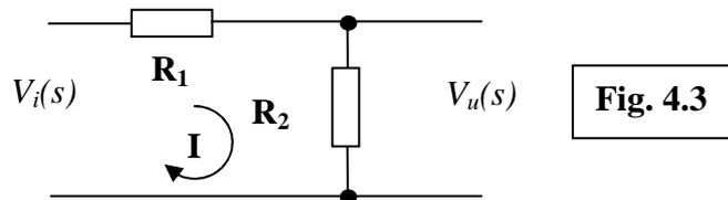
Per esso  $V_u = R_2 * I$ ; d'altra parte  $I = V_i / (R_1 + R_2)$ .
