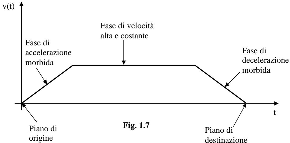
Il profilo di velocità viene appositamente studiato in modo che l'accelerazione in partenza e la decelerazione in arrivo non diano fastidio.
